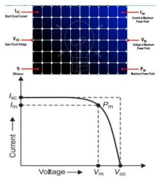
Figure 1 Solar cell parameters
